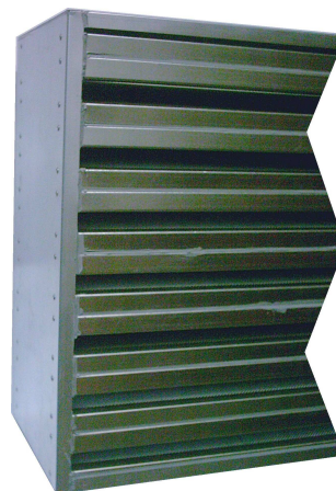
Aktivkohlezelle 610 x 610 x 292 mm 15 Einzelplatten mit je 25 mm Stärke. Metallgehäuse aus verzinktem Stahlblech
