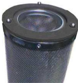
Die neu, blau verzinkten Patronen werden mit frischer Kohle gefüllt, wobei wir standardmäßig eine nicht imprägnierte, entstaubte 3mm Formkohle aus Steinkohle einsetzen. Sonderkohlen werden auf Wunsch ebenfalls verarbeitet. Als Dichtung verwenden wir ein, in sich geschlossenzelliges Zellkautschuk mit einer Stärke von 4 mm. Die Dichtung kann auf Wunsch in 2 unterschiedlichen Shorehärten geliefert werden.
